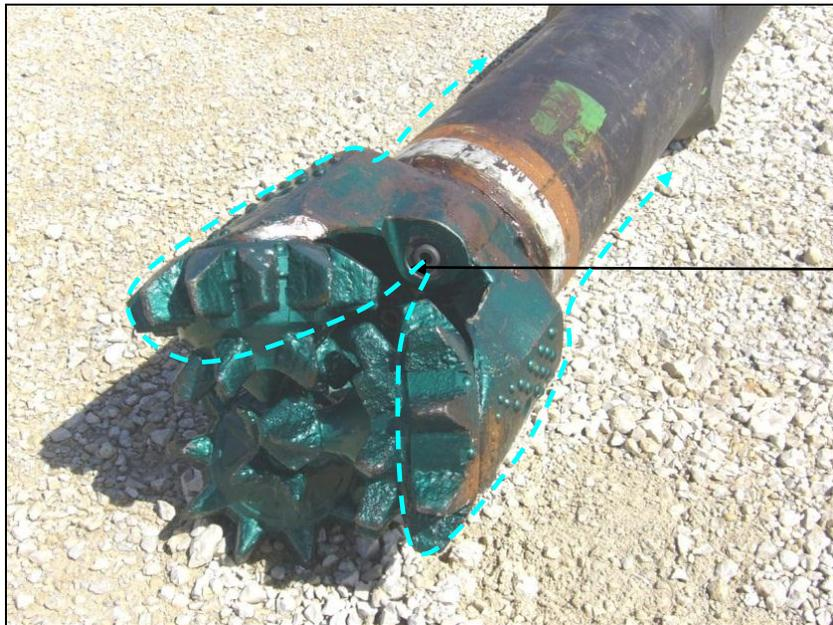
une des trois duses permettant la circulation du fluide de forage
